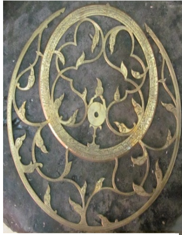
لوح ۴: عنکبوتیه در اسطرلاب با تکنیک مشبک کاری و تزئینات گیاهی اسلیمی
